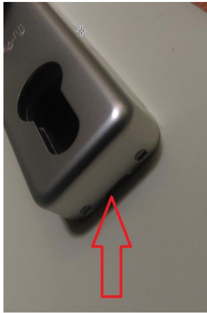
Cover klikkes af med skruetrækker i bund og top
