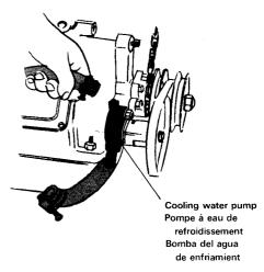
[4-3] Retirar las tuberías de entrada y salida para la bomba de agua de enfriamiento, luego, hacer girar el motor varias veces mediante la\_ palanca de arranque, para descargar el agua del interior de la bomba del agua de enfriamiento. Después de realizar el procedimiento descrito, conectar nuevamente las tuberías.
