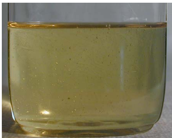
Hydraulikolie med vand på bunden
