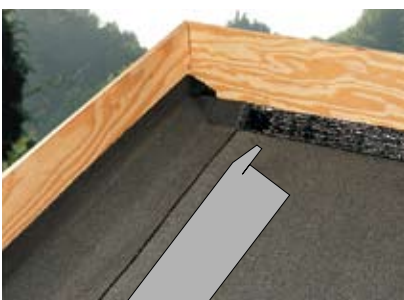
Indvendigt hjørne: Første understrimmel vist som principskitse
