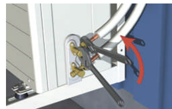
28. Fest rørene til utedelen. Dra godt til (se pkt 25). Hold imot med fastnøkkel eller skiftenøkkel (se bildet) så du ikke knekker noe!
