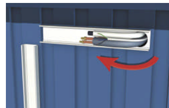
24. Bøy forsiktig rørene slik at de kommer i riktig lengderetning.
